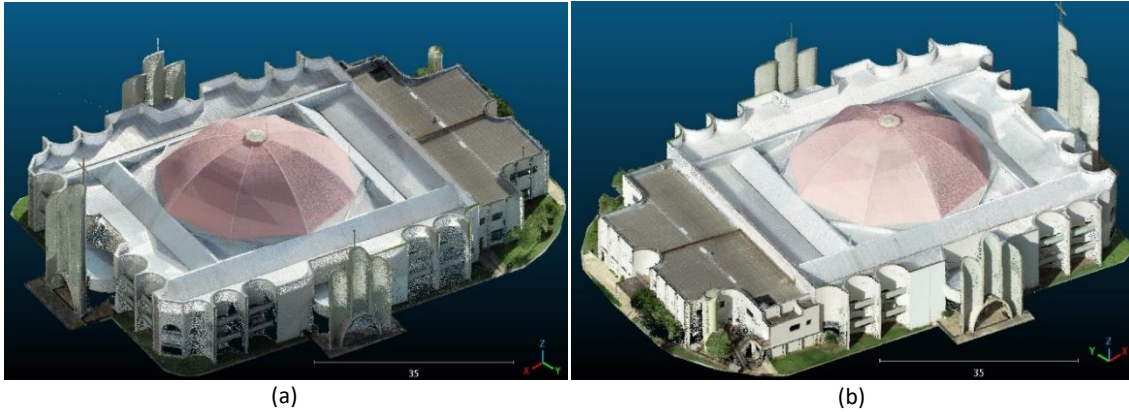
Figura 6 – Visualização por dois pontos de vista (a,b) da nuvem de pontos do segundo voo oblíquo laser no modo não repetitivo com registro de dois retornos
