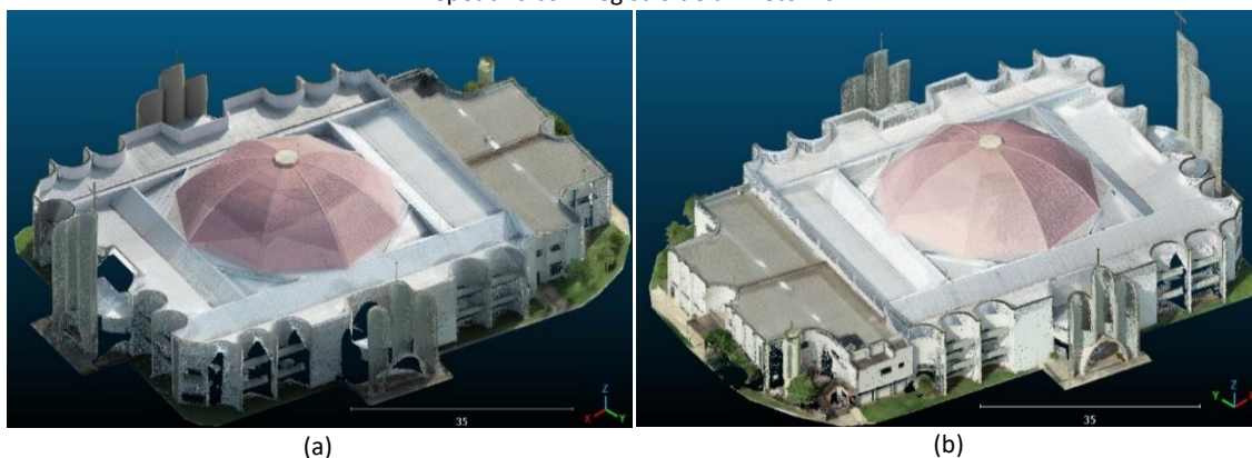
Figura 5 – Visualização por dois pontos de vista (a,b) da nuvem de pontos do primeiro voo oblíquo laser no modo repetitivo com registro de um retorno.
