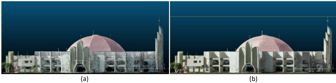
Figura 7 – Nuvem de pontos do sistema LiDAR no (a) modo repetitivo com registro do primeiro pulso e no (b) modo não repetitivo com registro dos dois primeiros pulsos.
